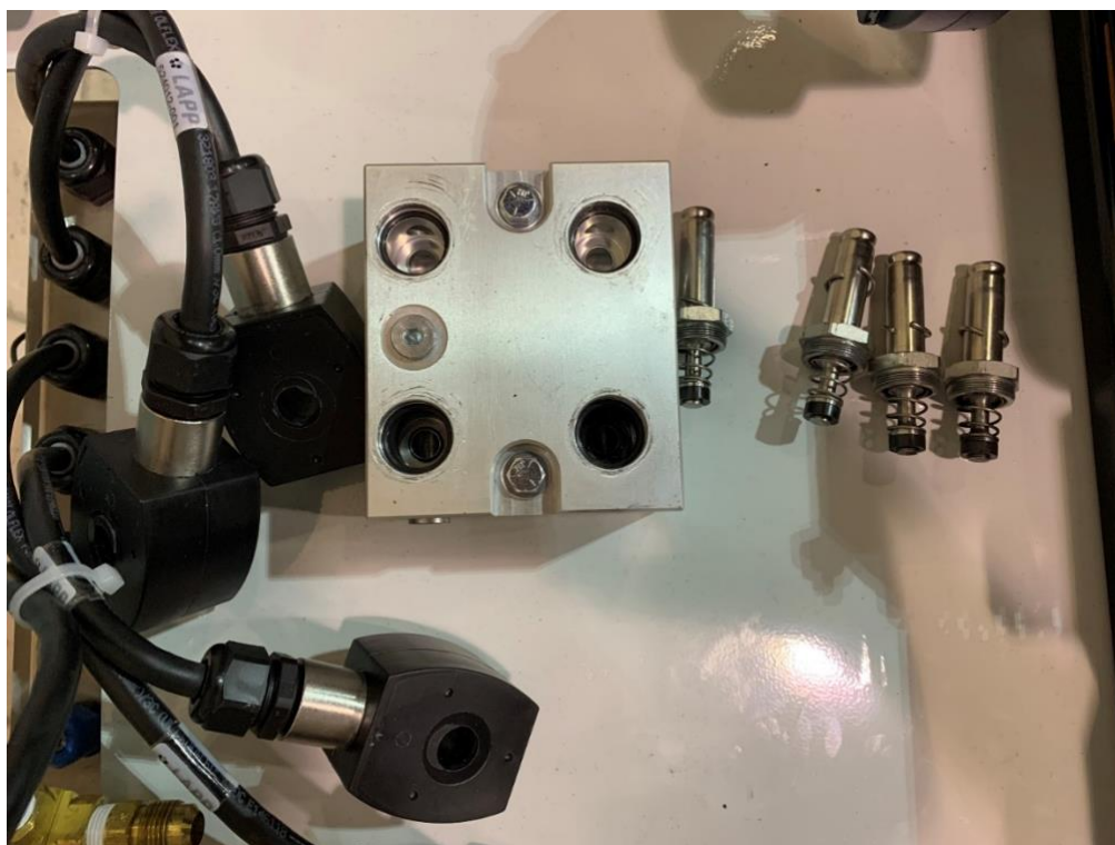
Figura 9-19: Colector con los solenoides retirados, mostrando las bases de solenoides
