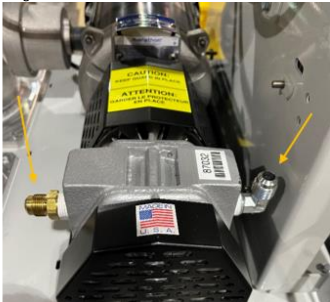
Figura 9-8: Retire los dos tubos en la bomba
