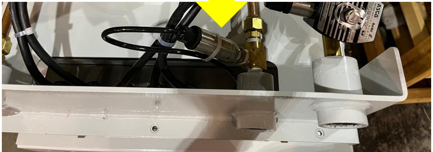
Figura 9-7: Sensor de presión instalado en la GREEN MACHINE
