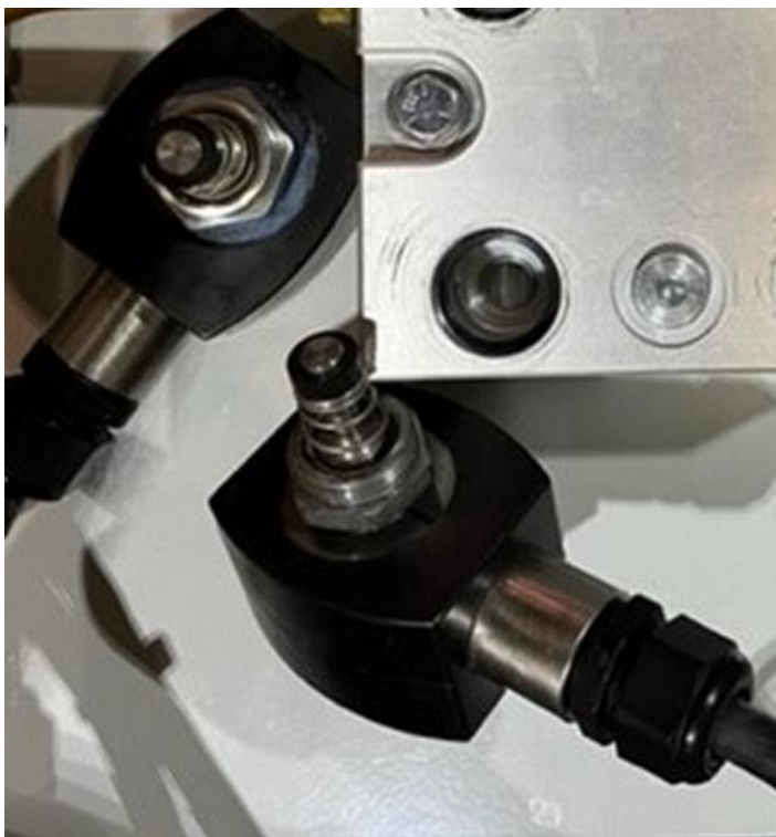
Figura 9-21: Solenoides (con las bases para solenoides instaladas) acomodados y apartados
