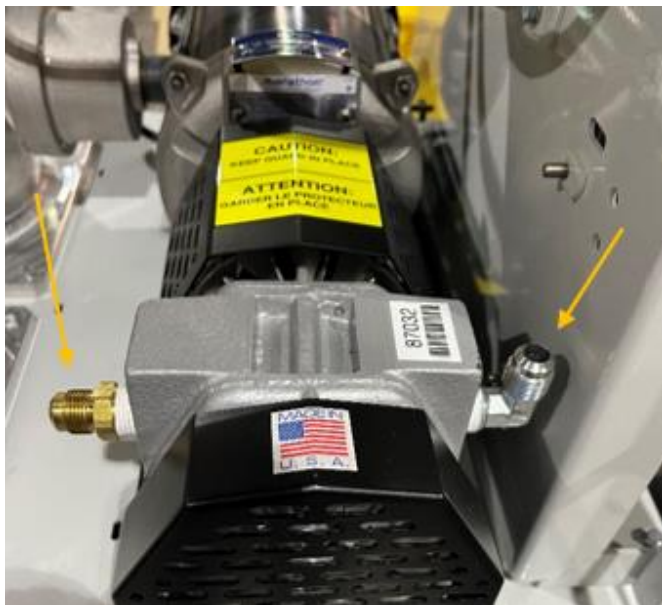
Figura 9-6: Retire los dos tubos en la bomba
