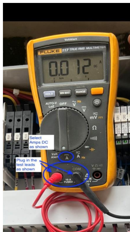
Figura 8-14: Ejemplo con multímetro de Fluke configurado para medir corriente continua de 4-20 mA
