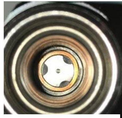
Figura 7-12: Interior de la base del solenoide
