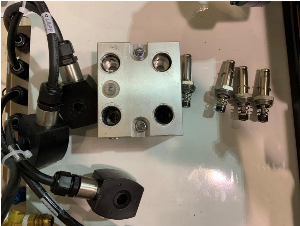
Figura 9-22: Conjunto y componentes de la válvula de control GM
