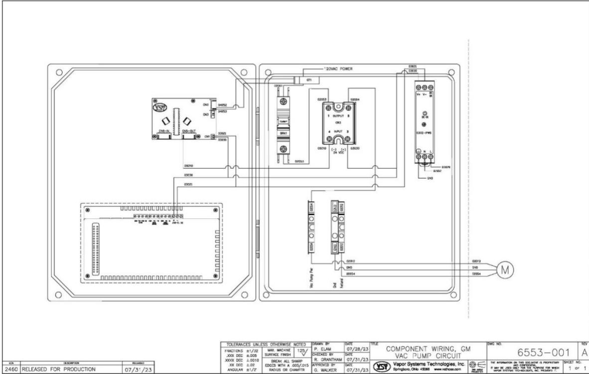
Figura 8-22: Circuito de bomba de vacío
