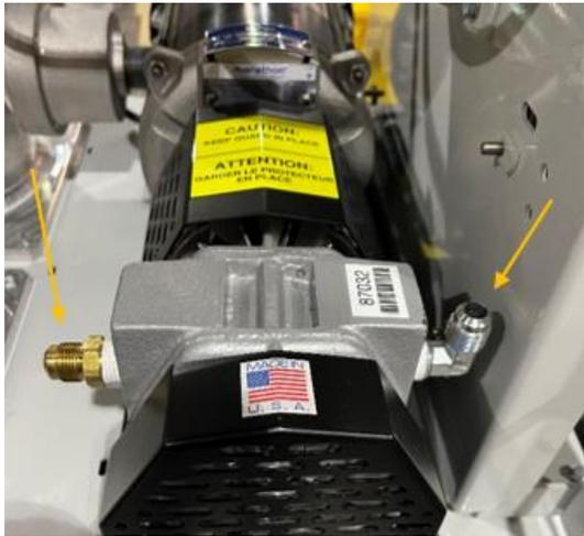
**Figura 7-8: Retire los dos tubos en la bomba.**
