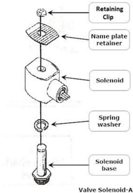
Figura 9-11: : Conjunto del solenoide de la válvula
