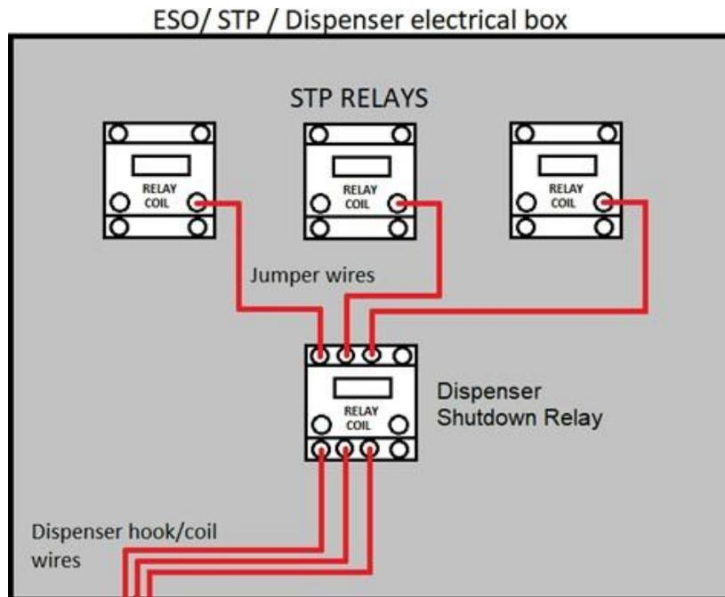
Figura 3-11: Cables de relés STP al relé CS12A
