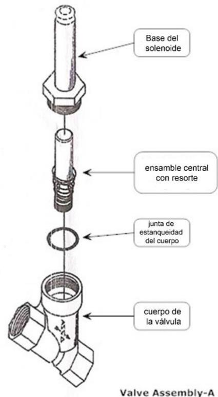
Figura 7-13: Conjunto del solenoide de la válvula
