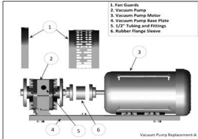
Figura 7-9: Retire la protección del ventilador de costado.
