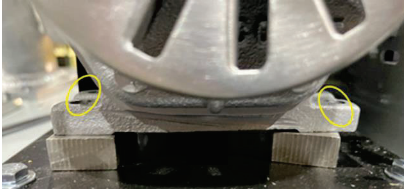
Figura 9-18: Retire los 4 pernos de montaje de la base de la bomba de vacío
