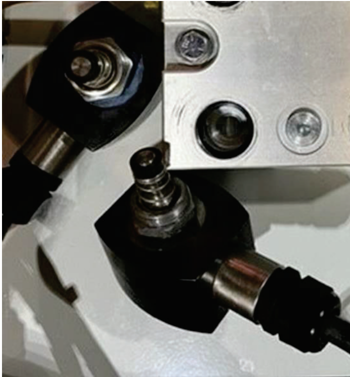
Figura 9-23: Solenoides (con las bases para solenoides instaladas) acomodados y apartados
