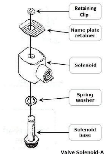
Figura 9-11: : Conjunto del solenoide de la válvula
