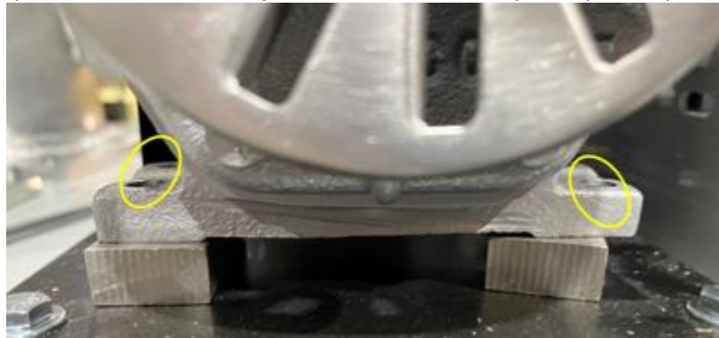
Figura 7-10: Retire los 4 pernos de montaje del motor de la placa base del motor.
