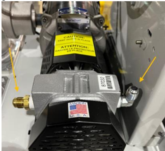
Figura 9-16: Retire los conectores de bronce de la tubería de ambos lados de la bomba de vacío
