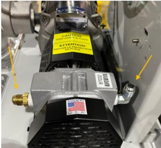
Figura 9-8: Retire los dos tubos en la bomba
