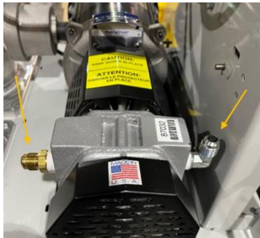
Figura 7-8: Retire los dos tubos en la bomba.
