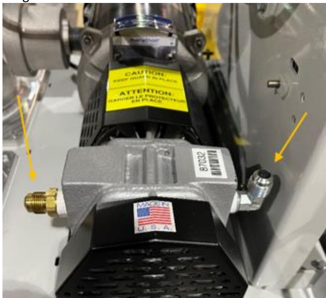
Figura 9-8: Retire los dos tubos en la bomba
