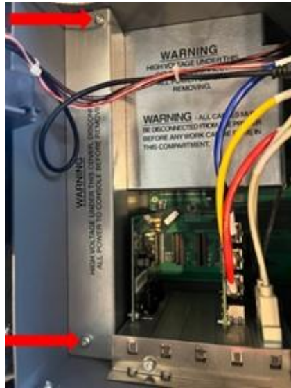
Figura 3-7: Tornillos del panel de la bahía de comunicación
