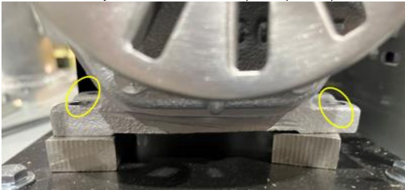
Figura 9-10: Retire los 4 pernos de montaje del motor de la placa base del motor
