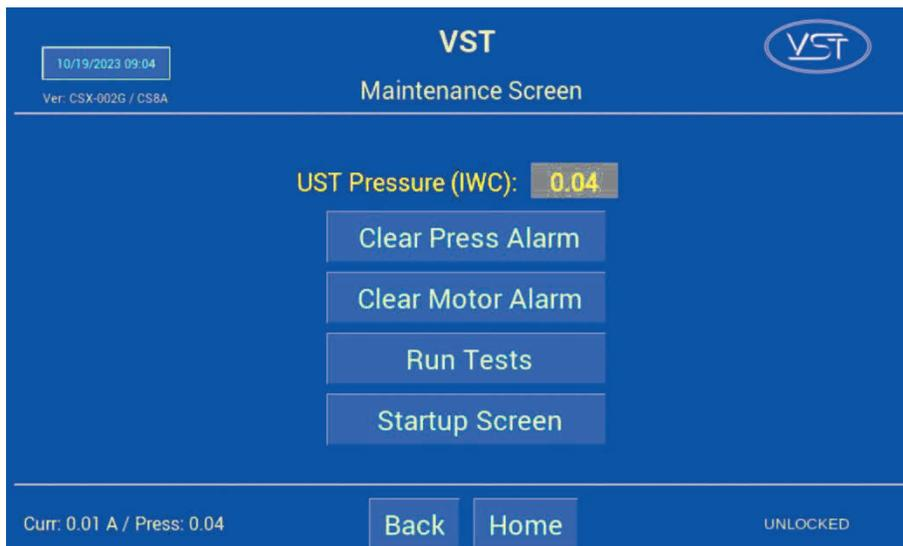
Figura 7-3: Pantalla de mantenimiento
