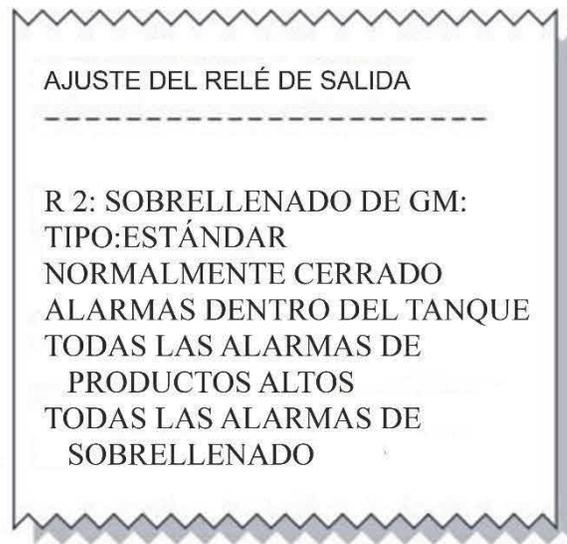
Figura 6-11: Configuración del relé de salida
