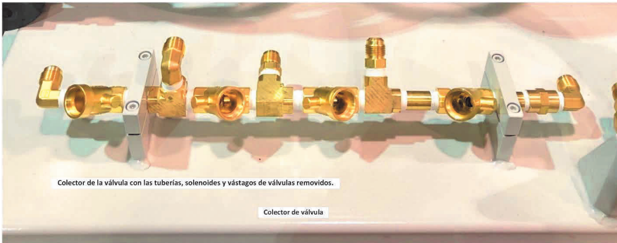
Colector de válvula con todos los accesorios removidos, 24/01/2019
