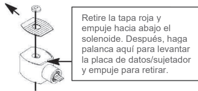
Figura 9-27: Cómo retirar el tapón rojo de la base del solenoide
