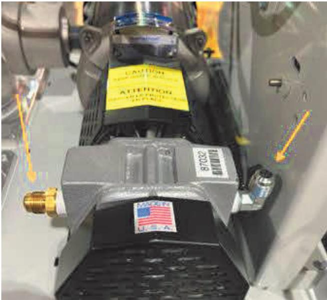
Figura 9-8: Retire los dos tubos en la bomba
