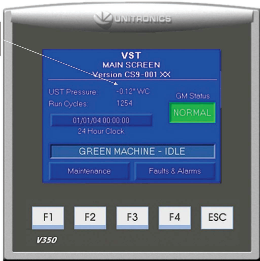
Pantalla principal con lectura de presión de la MX GM CS9, 27-02-2019
