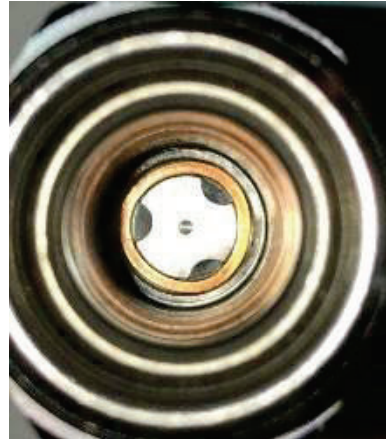
Figura 7-15: Interior de la base del solenoide
