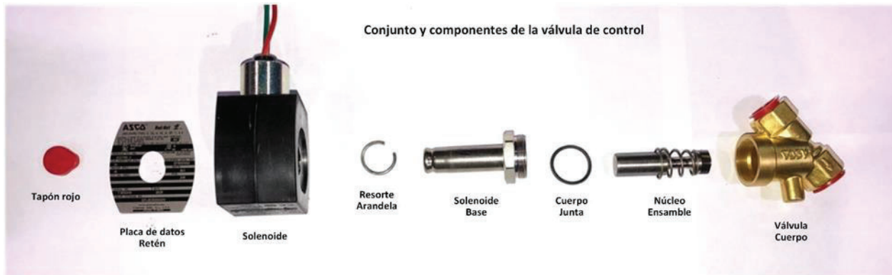
Conjunto y componentes de la válvula de control de la GM, 01-25-2019
