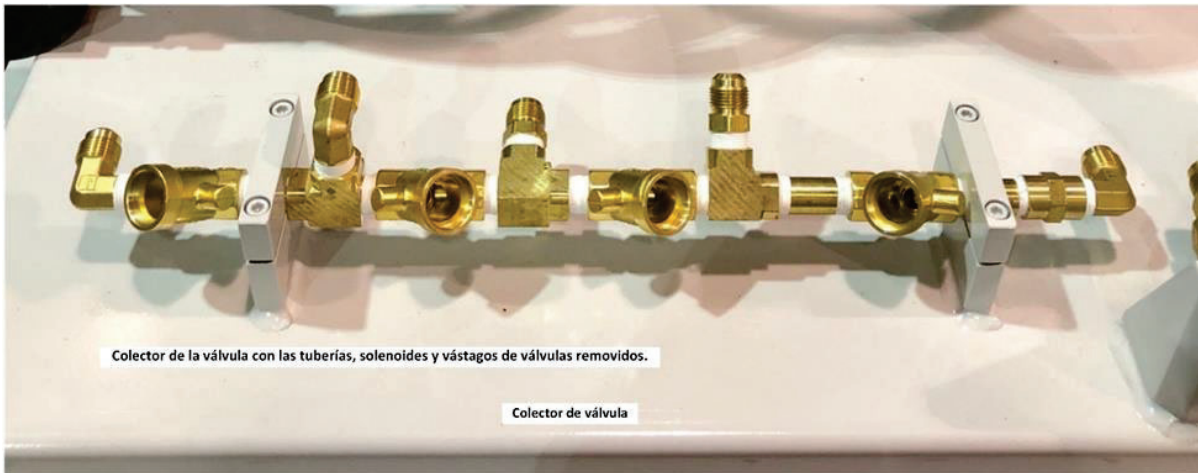
Figura 9-28: Colector con los solenoides retirados, mostrando las bases de solenoides
