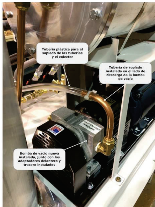
Figura 9-33: Bomba de vacío con tubo de escape instalado
