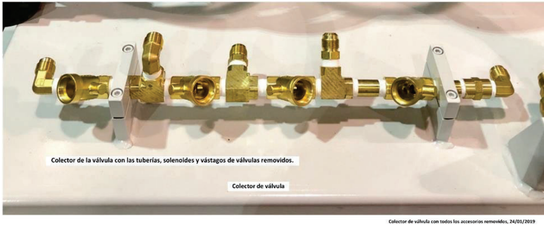
Figura 9-32: Colector listo para su limpieza
