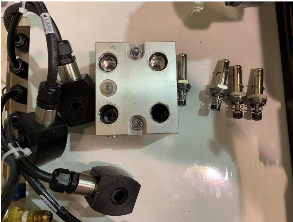
Figura 9-20: Conjunto y componentes de la válvula de control GM
