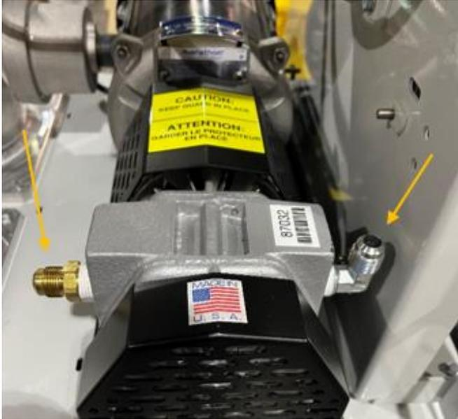
Figura 9-6: Retire los dos tubos en la bomba
