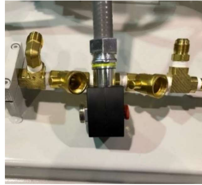
Figura 9-30: Solenoide con la base y tapón ROJO instalados.
