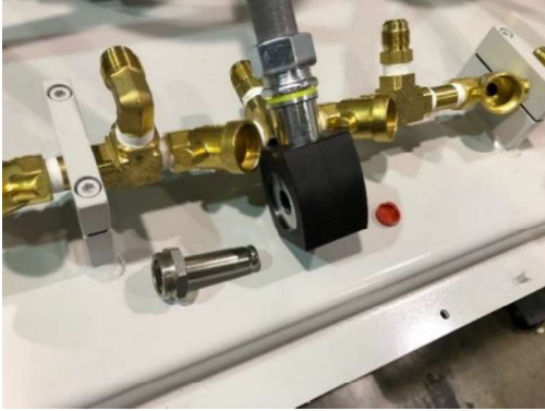
Figura 9-29: solenoide con la base y tapón ROJO
