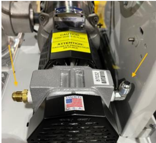
Figura 7-8: Retire los dos tubos en la bomba.
