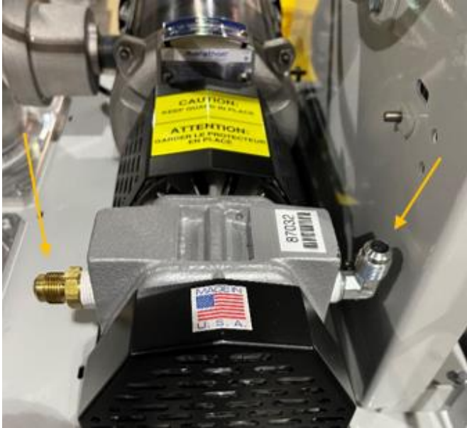
Figura 9-6: Retire los dos tubos en la bomba
