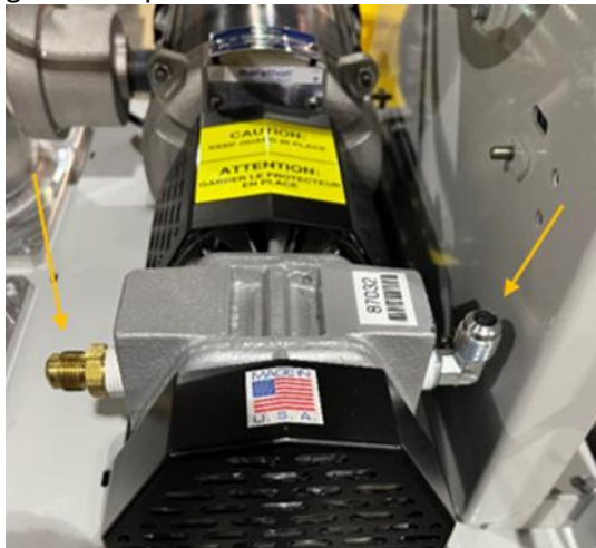
Figura 9-14: Retire los conectores de bronce de la tubería de ambos lados de la bomba de vacío
