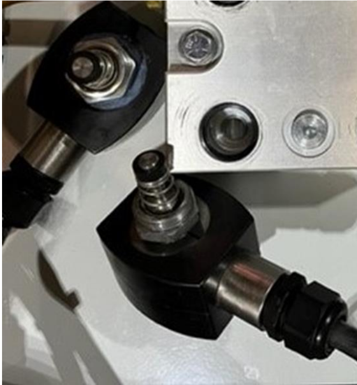
Figura 9-21: Solenoides (con las bases para solenoides instaladas) acomodados y apartados
