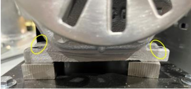
Figura 9-8: Retire los 4 pernos de montaje del motor de la placa base del motor
