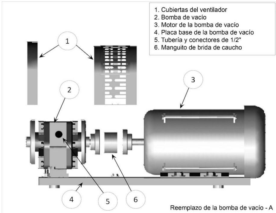
Figura 9-21: Componentes de la bomba de vacío
