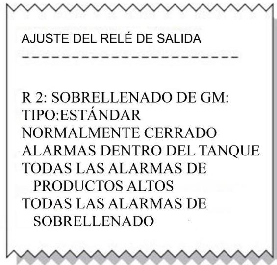
**Figura 6-11: Configuración del relé de salida**
