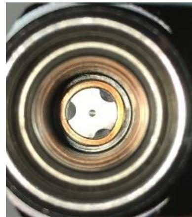
Figura 7-15: Interior de la base del solenoide
