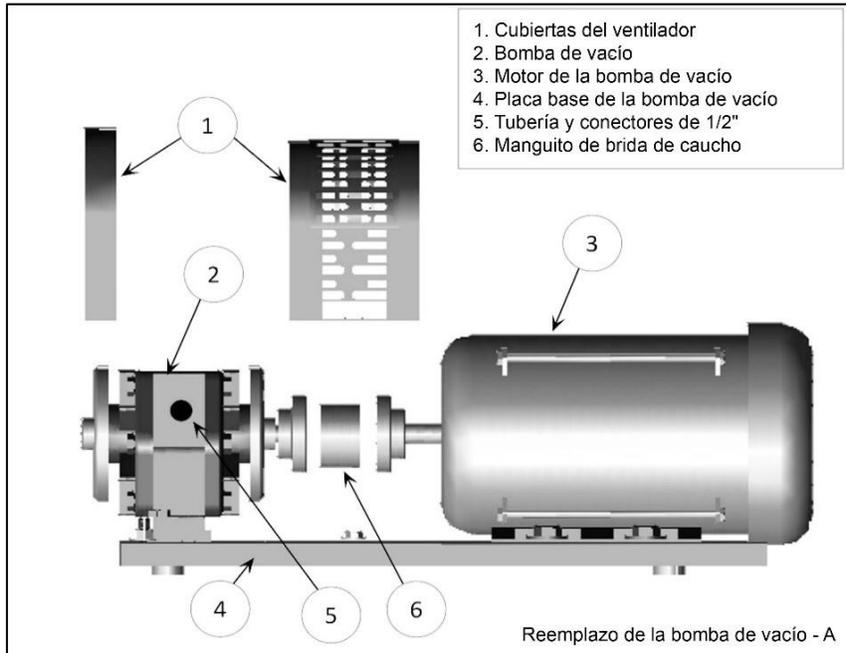
Figura 9-16: Componentes de la bomba de vacío
