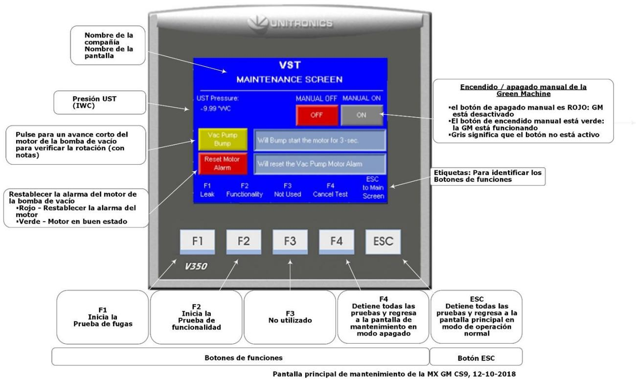
Figura 4-3: Descripción de la pantalla de mantenimiento
