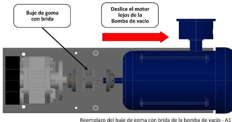
**Figura 9-15: Reemplazo del mango de brida de goma**
