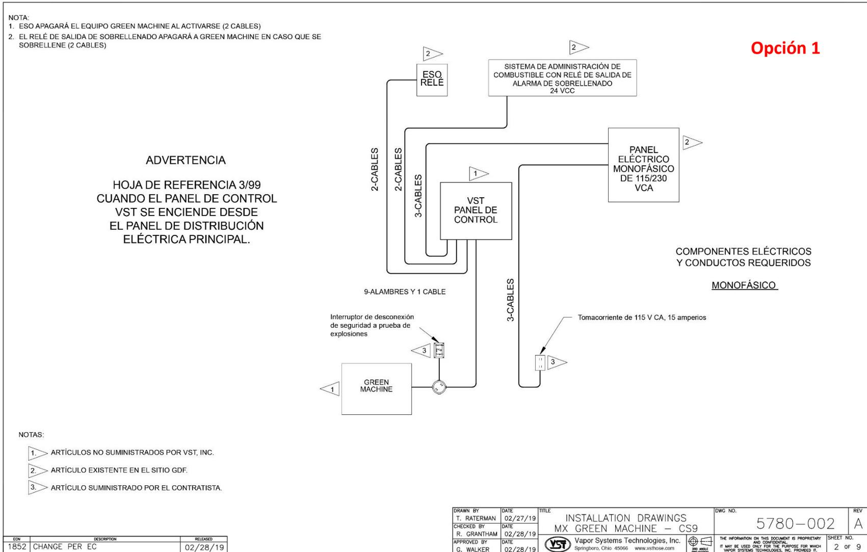
Figura 8-5: Diagrama de cableado eléctrico de campo
