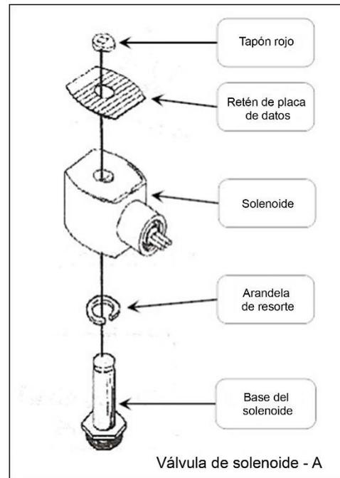
Figura 9-18: Ensamble de la válvula solenoide
