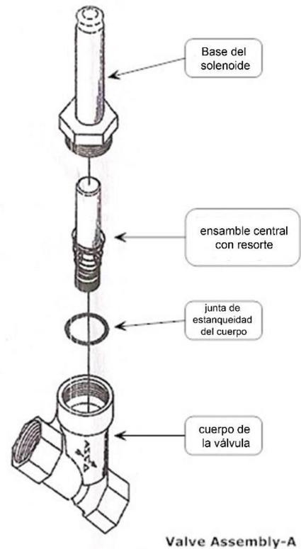
Figura 7-16: Ensamblaje del solenoide de la válvula
