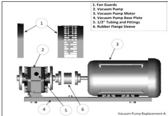
Figure 7-9: Retire la protección del ventilador de costado.
