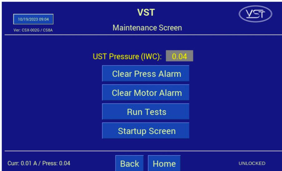
Figure 7-3: Pantalla de mantenimiento
