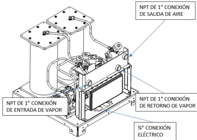
Figure 7-7: Diagrama de operación de la GREEN MACHINE
