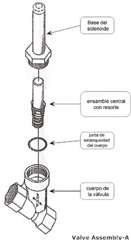
Figure 7-13: Conjunto del solenoide de la válvula
