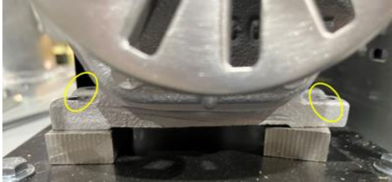
Figure 7-10: Retire los 4 pernos de montaje del motor de la placa base del motor.
