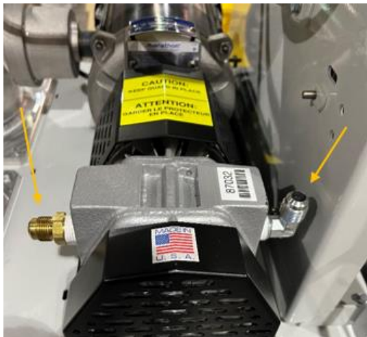
Figure 7-8: Retire los dos tubos en la bomba.
