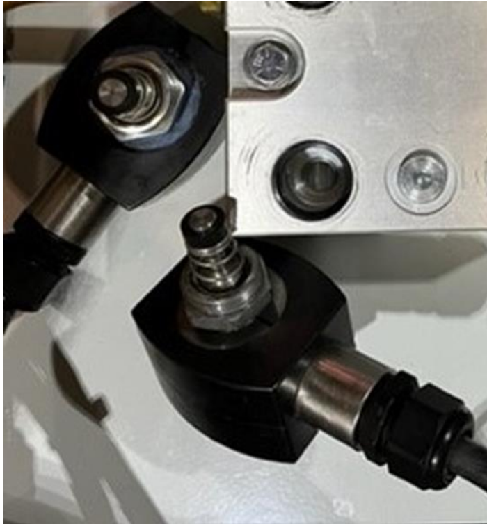
Figure 9-24: Solenoides (con las bases para solenoides instaladas) acomodados y apartados
