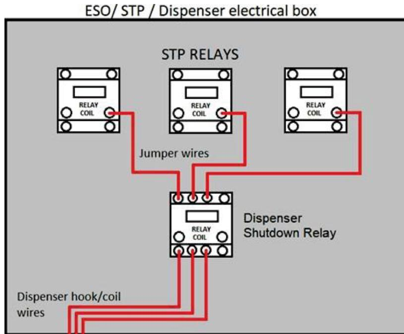
Figure 3-11: Cables de relés STP al relé CS12A
