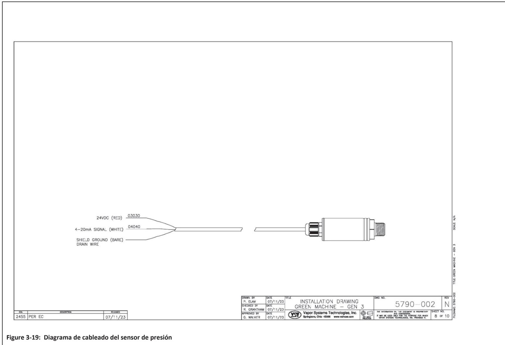
Figure 3-19: Diagrama de cableado del sensor de presión
