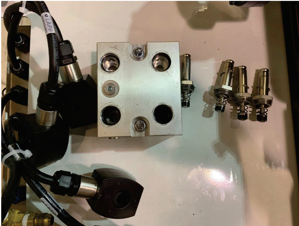
Figure 9-23: Conjunto y componentes de la válvula de control GM
