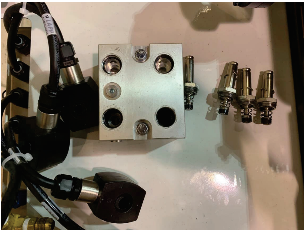
Figura 9-20: Colector con los solenoides retirados, mostrando las bases de solenoides
