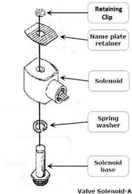
Figure 9-12: : Conjunto del solenoide de la válvula
