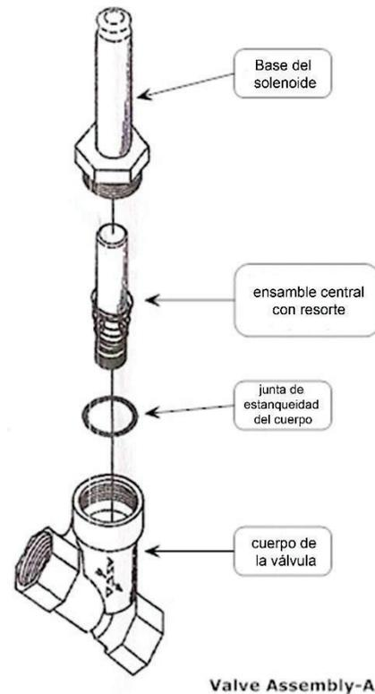
Figure 9-13: Conjunto de la válvula
