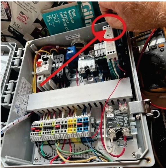
Figura 8-10: Conecte la batería al lado "-" y "V-"
