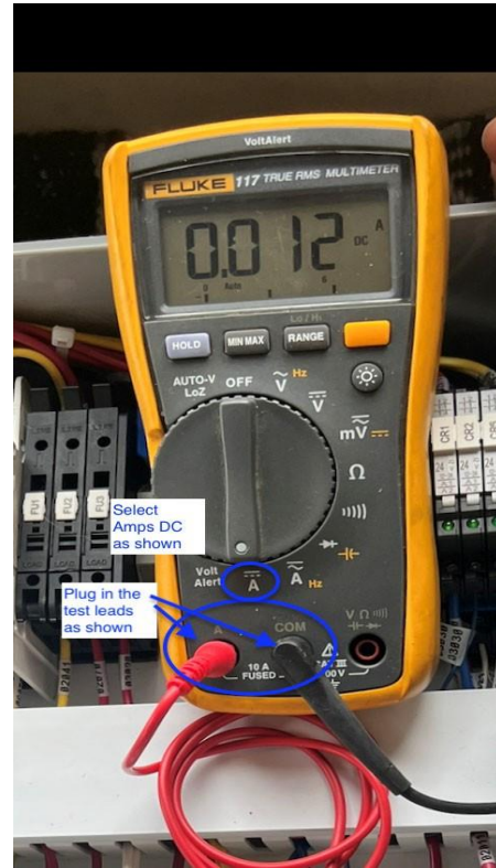
Figura 8-14: Ejemplo con multímetro de Fluke configurado para medir corriente continua de 4-20 mA
