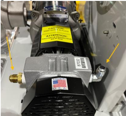
Figura 9-15: Retire los conectores de bronce de la tubería de ambos lados de la bomba de vacío
