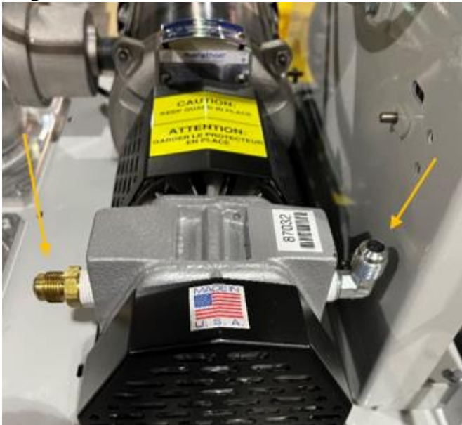
Figura 9-7: Retire los dos tubos en la bomba
