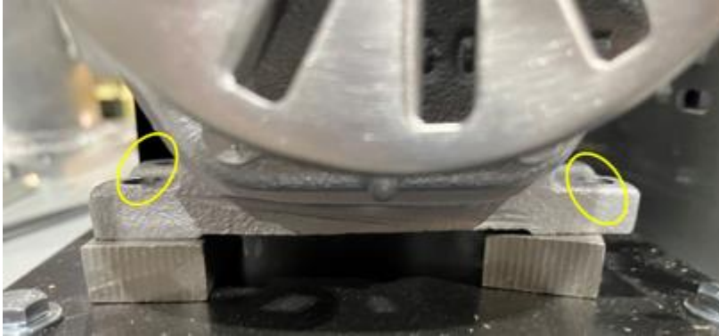
Figura 9-9: Retire los 4 pernos de montaje del motor de la placa base del motor
