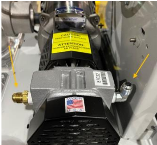
Figura 7-8: Retire los dos tubos en la bomba.
