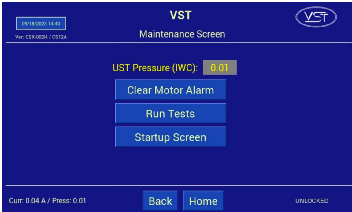
Figure 9-28: Pantalla de mantenimiento
