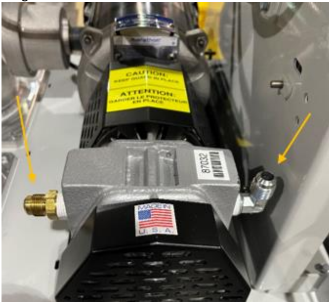
Figure 9-9: Retire los dos tubos en la bomba
