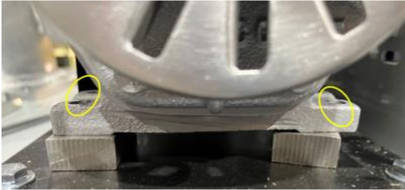
Figure 9-11: Retire los 4 pernos de montaje del motor de la placa base del motor
