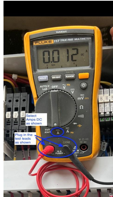
Figure 8-14: Ejemplo con multímetro de Fluke configurado para medir corriente continua de 4-20 mA
