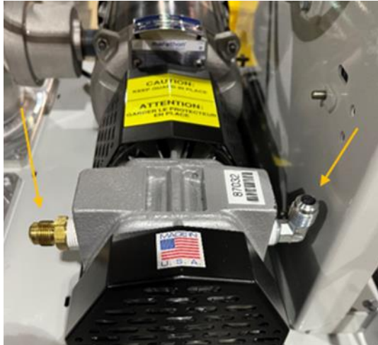
Figure 9-17: Retire los conectores de bronce de la tubería de ambos lados de la bomba de vacío
