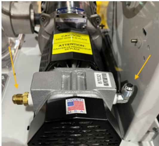
Figure 7-8: Retire los dos tubos en la bomba.
