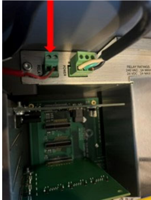
Figure 3-8: Ubicación del relé R7 que muestra el cable de sobrellenado GM conectado en los terminales R7
