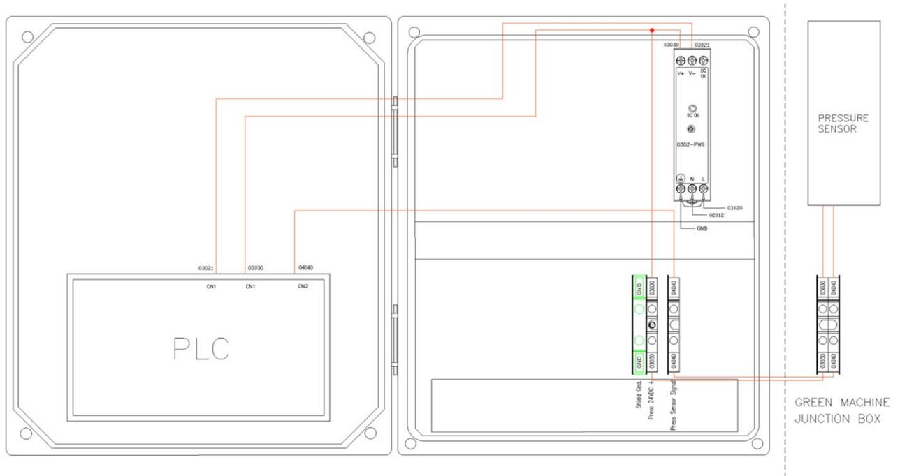
Figure 8-5 Diagrama de cableado del sensor de presión (alimentación de 24 VCC y señal de 4-20 mA)
