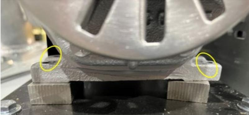
**Figure 9-9: Retire los 4 pernos de montaje del motor de la placa base del motor**
