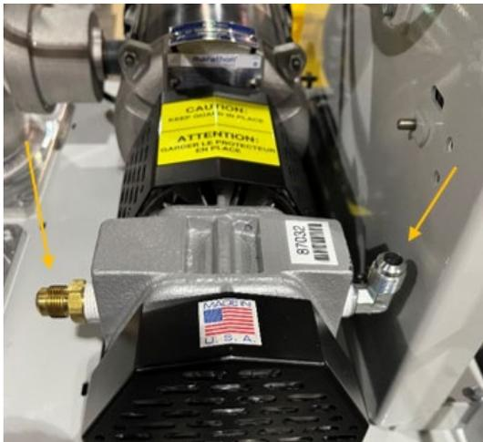
Figure 9-7: Retire los dos tubos en la bomba.
