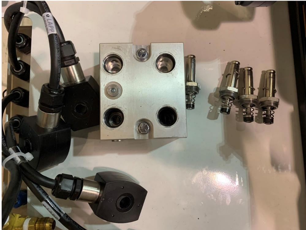
**Figure 9-21: Solenoides (con las bases para solenoides instaladas) acomodados y apartados**
