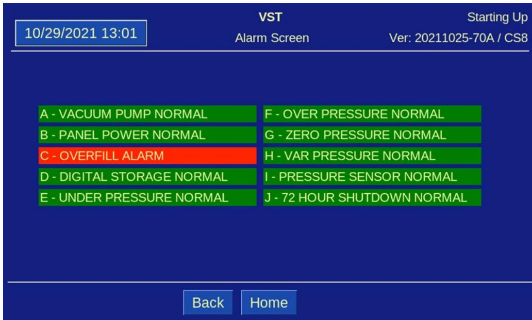
Figure 3-6 Pantalla de alarma del PLC del panel de control V
