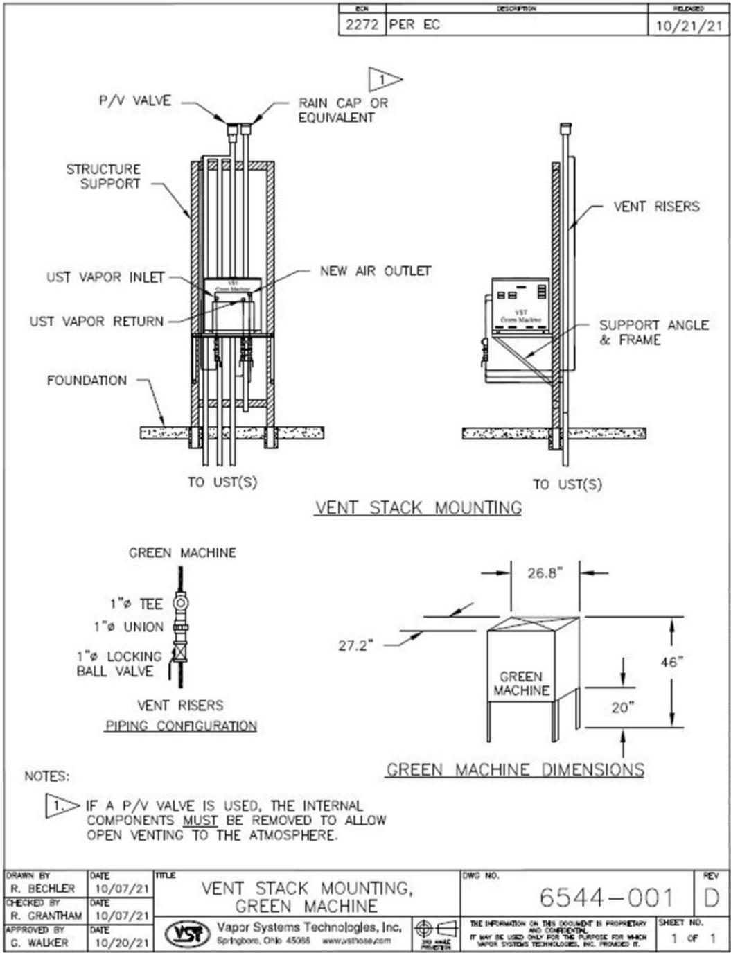
Figure 1-3: Instalación en la chimenea de ventilación
