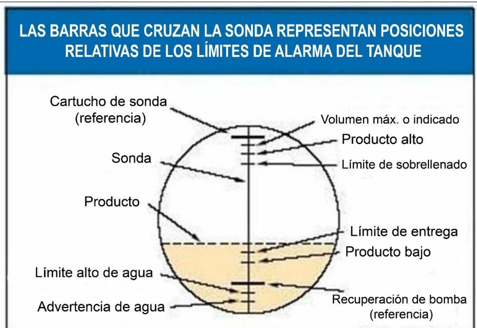
Figure 8-13: Alarmas de nivel del tanque de combustible
