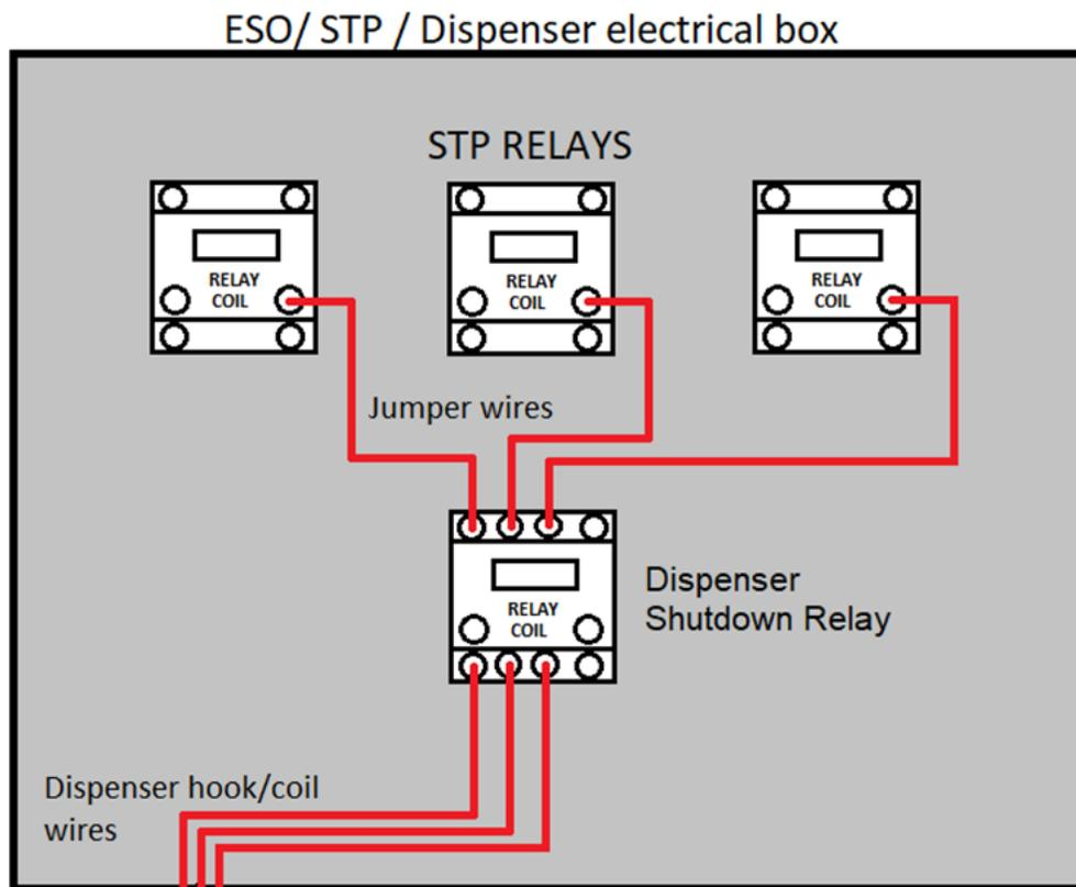
**Figure 3-4 Cables al rele del CS8 GREEN MACHINE**
