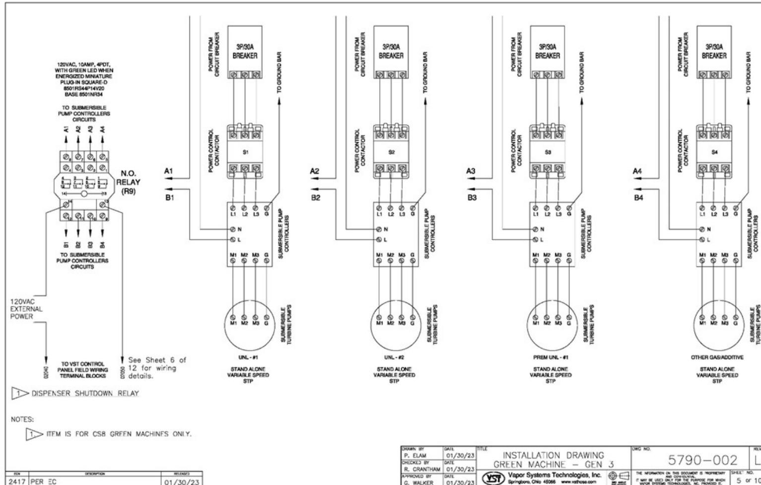
Figure 3-10 Desconexión de la estación - cableado del relé de enganche
