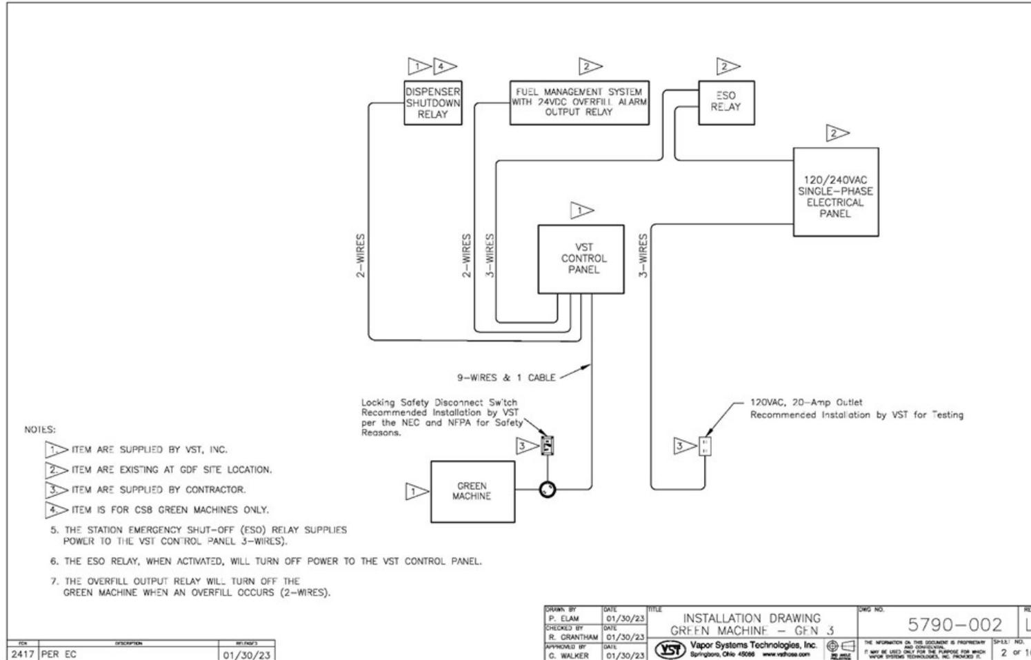
Figure 3-7 Descripción de la instalación de la GREEN MACHINE
