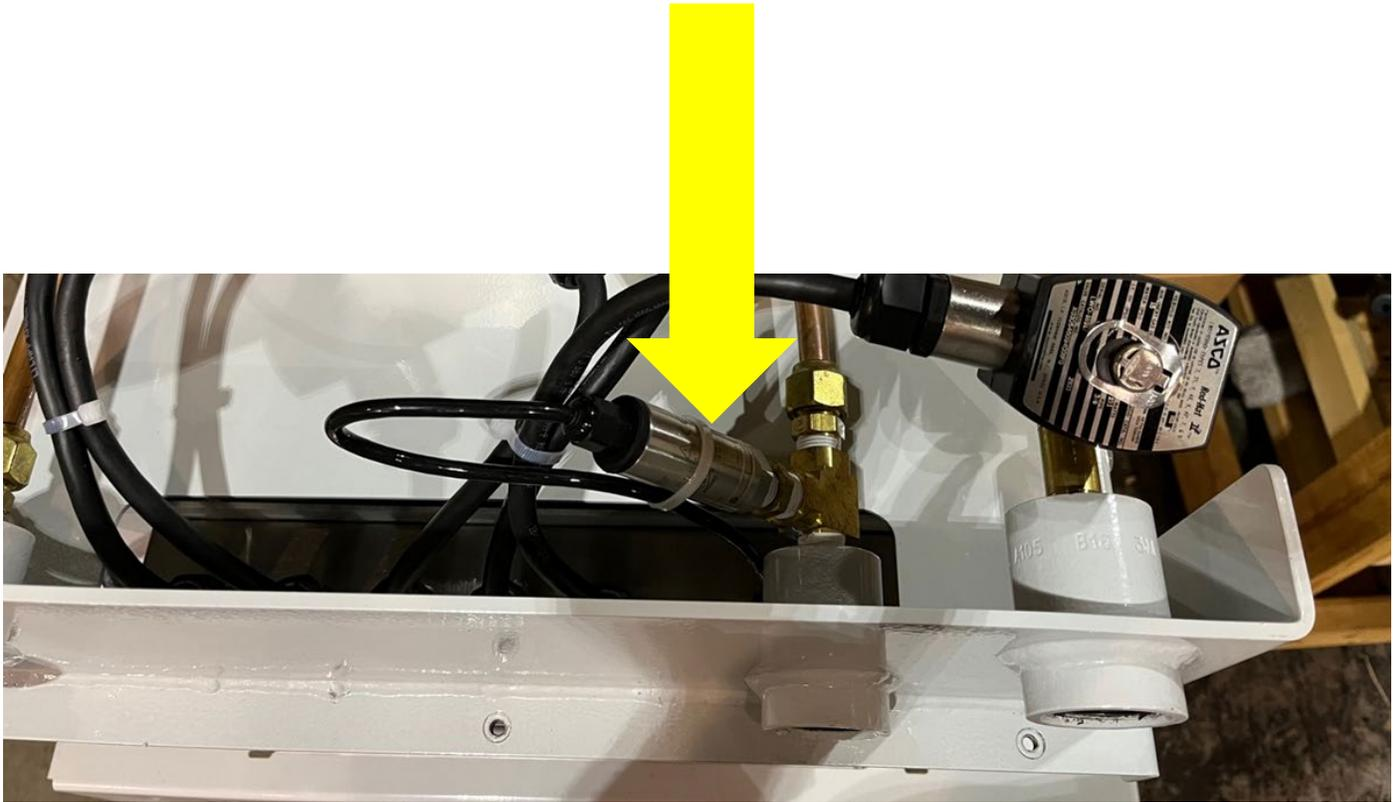
Figure 9-6: Sensor de presión instalado en la GREEN MACHINE
