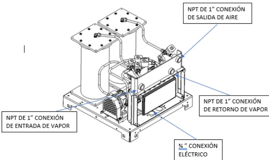
Figure 7-7: Diagrama de operación de la GREEN MACHINE
