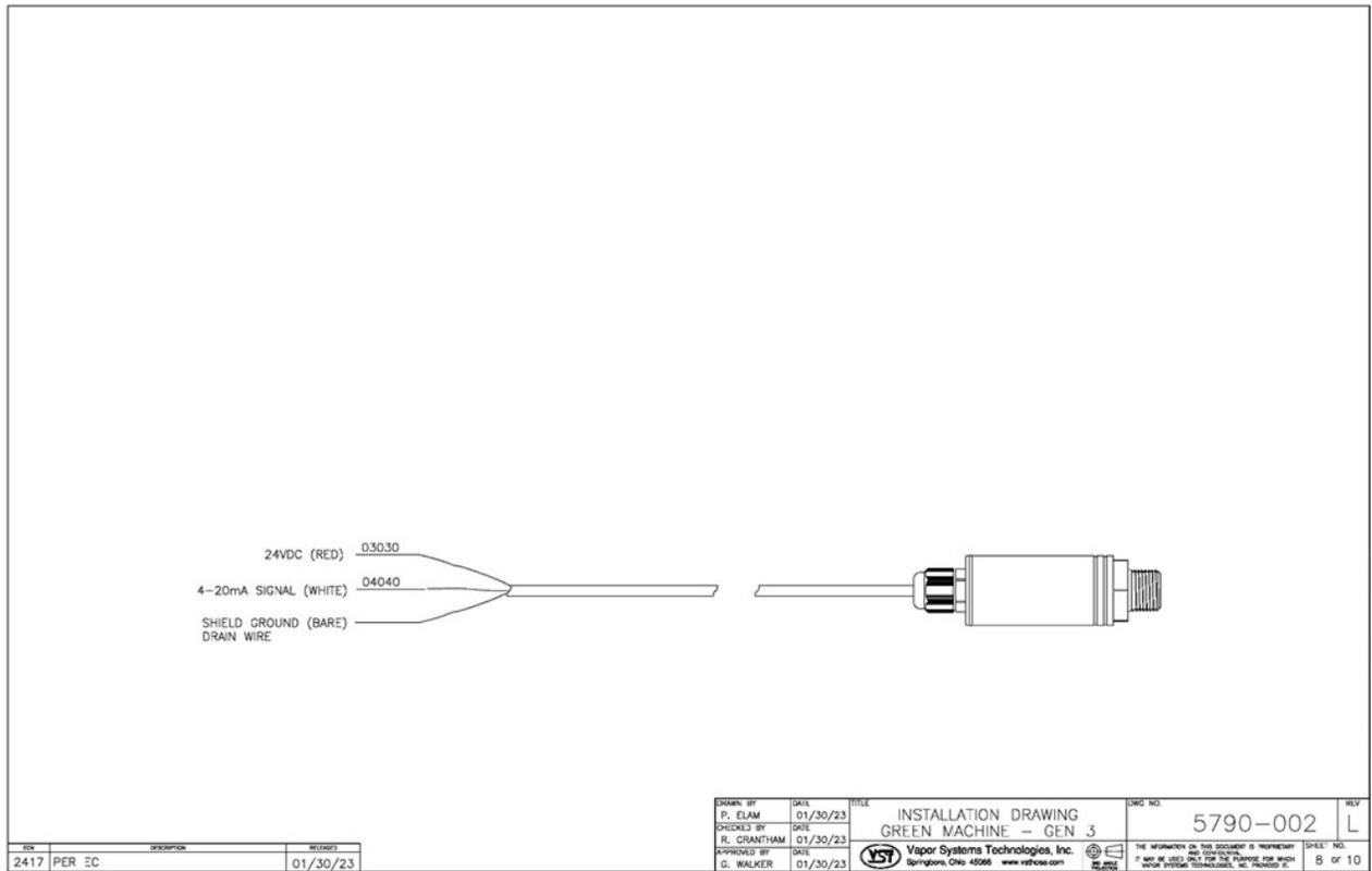
Figure 3-13 Diagrama de cableado del sensor de presión
