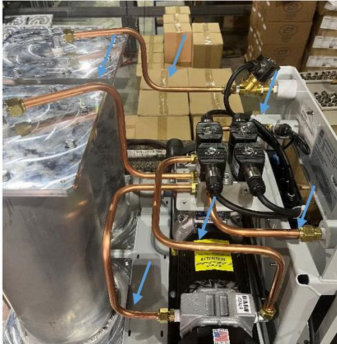
Figure 9-12: Tubería para retirar
