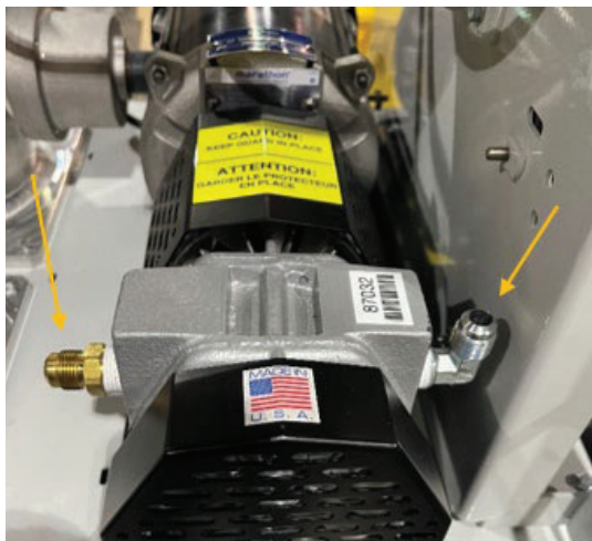
Figure 7-8: Retire los dos tubos en la bomba.
