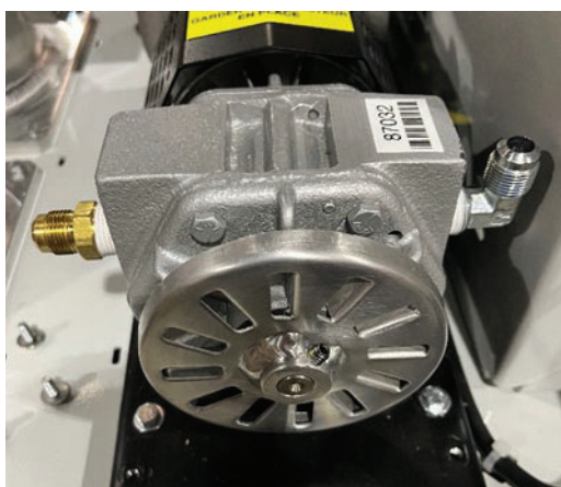
Figure 7-9: Retire la protección del ventilador de costado.
