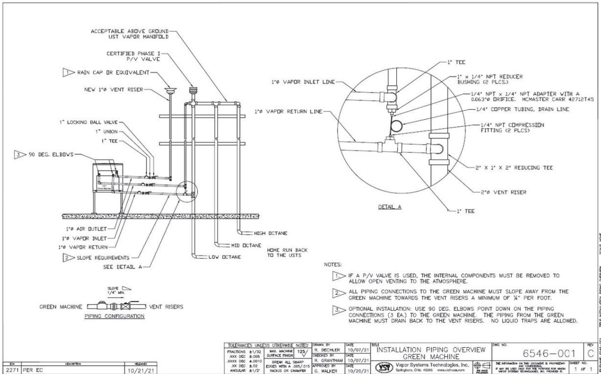
Figure 9-27: Descripción de las tuberías de vapor
