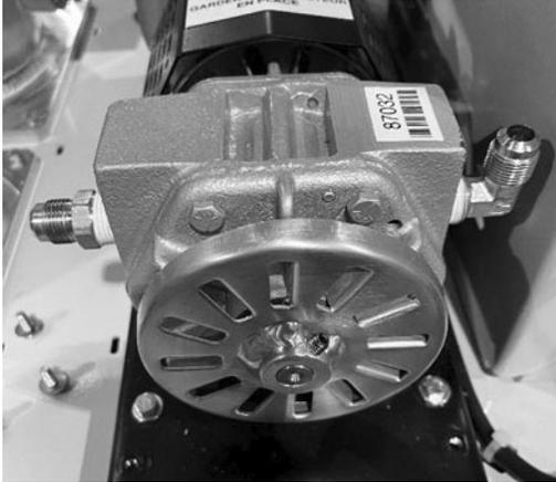
Figure 9-16: Retire la guarda del ventilador de costado
