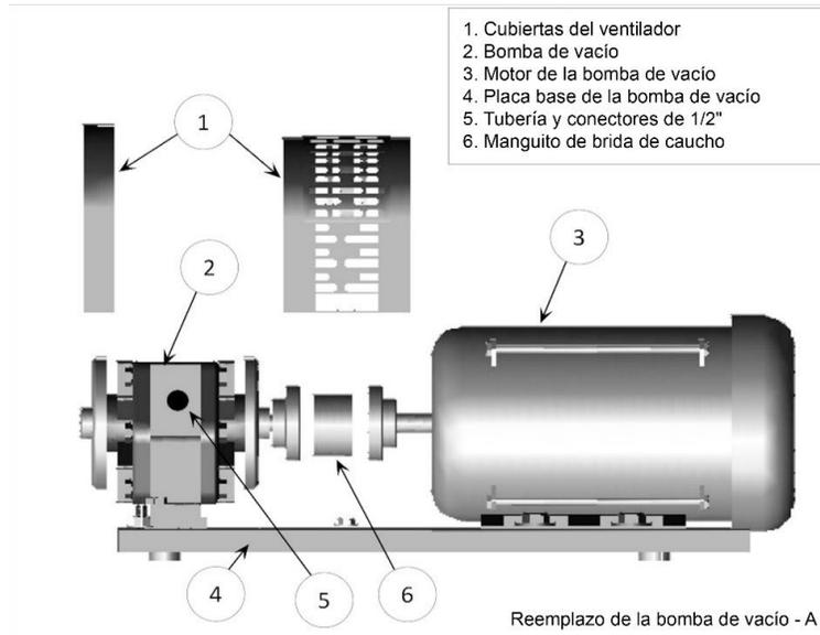
**Figure 9-14: Conjunto y componentes de la bomba de vacío**
