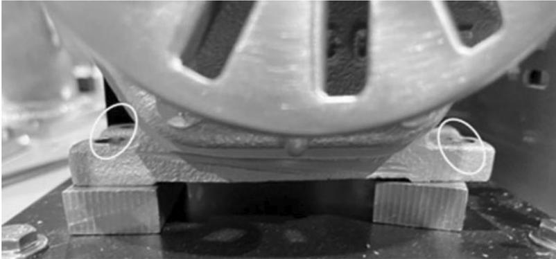
Figure 9-17: Retire los 4 pernos de montaje de la base de la bomba de vacío
