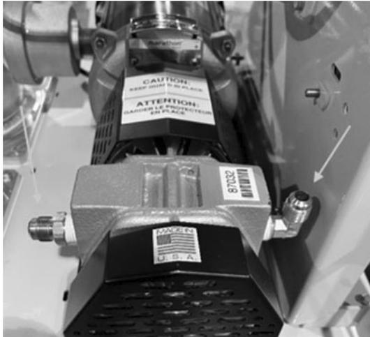
**Figure 9-15: Retire los conectores de bronce de la tubería de ambos lados**
