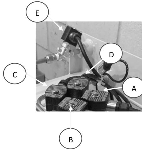
Figure 9-18: Válvulas del colector
