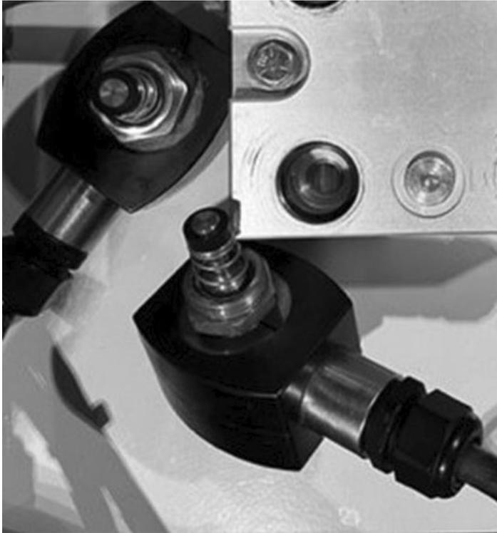
**Figure 9-22: Solenoides con el ensamblaje del núcleo en el interior**
