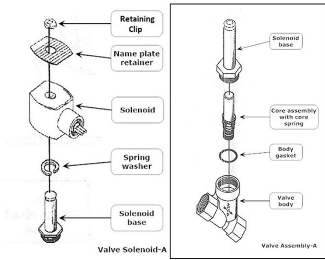
Figure 9-19: Conjunto y componentes de la válvula de control GM
