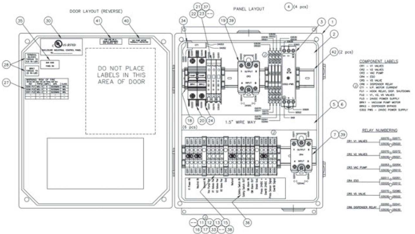
Figure 8-11: Componentes eléctricos del panel de control del VST
