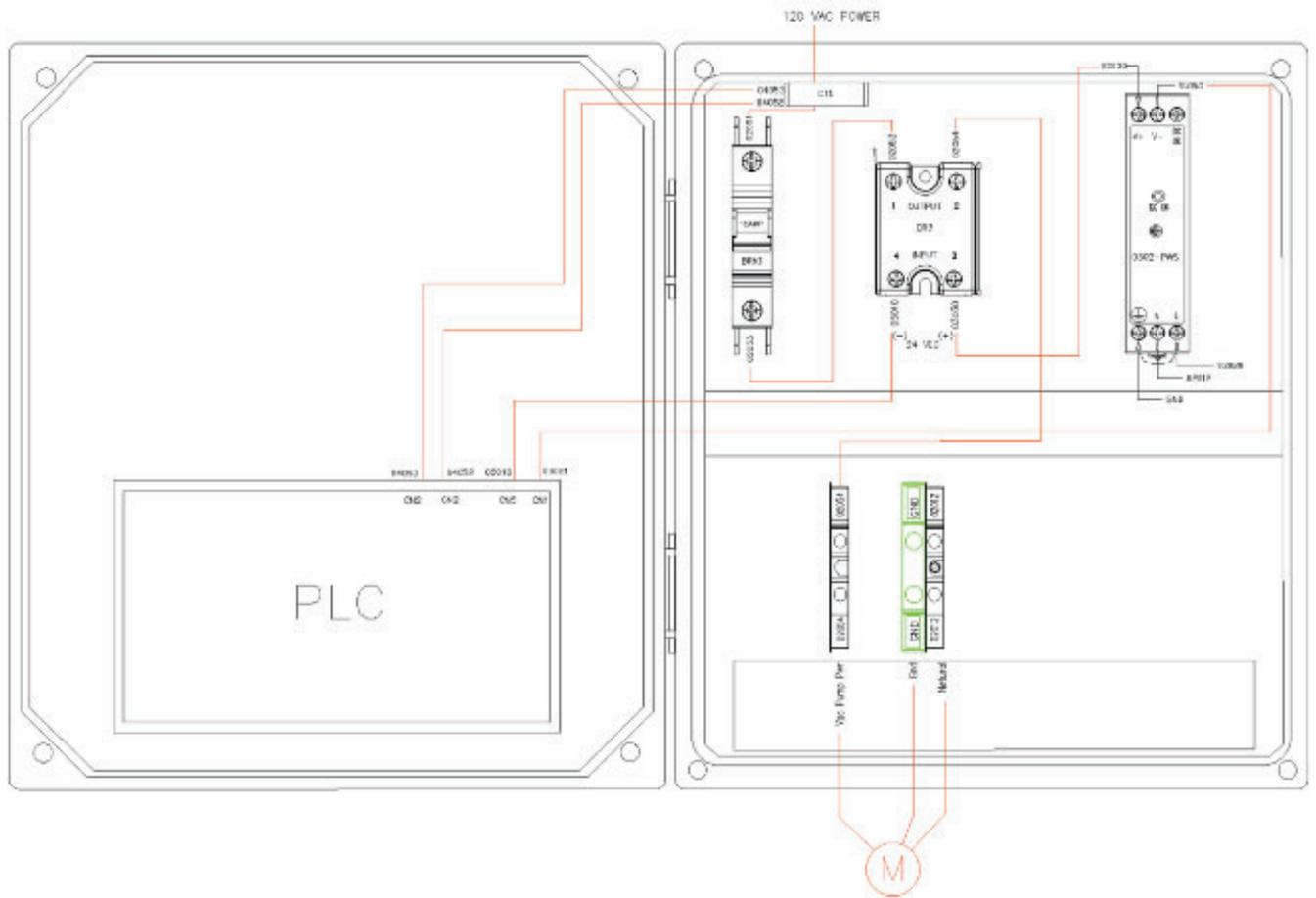
Figure 8-10: Circuito de bomba de vacío
