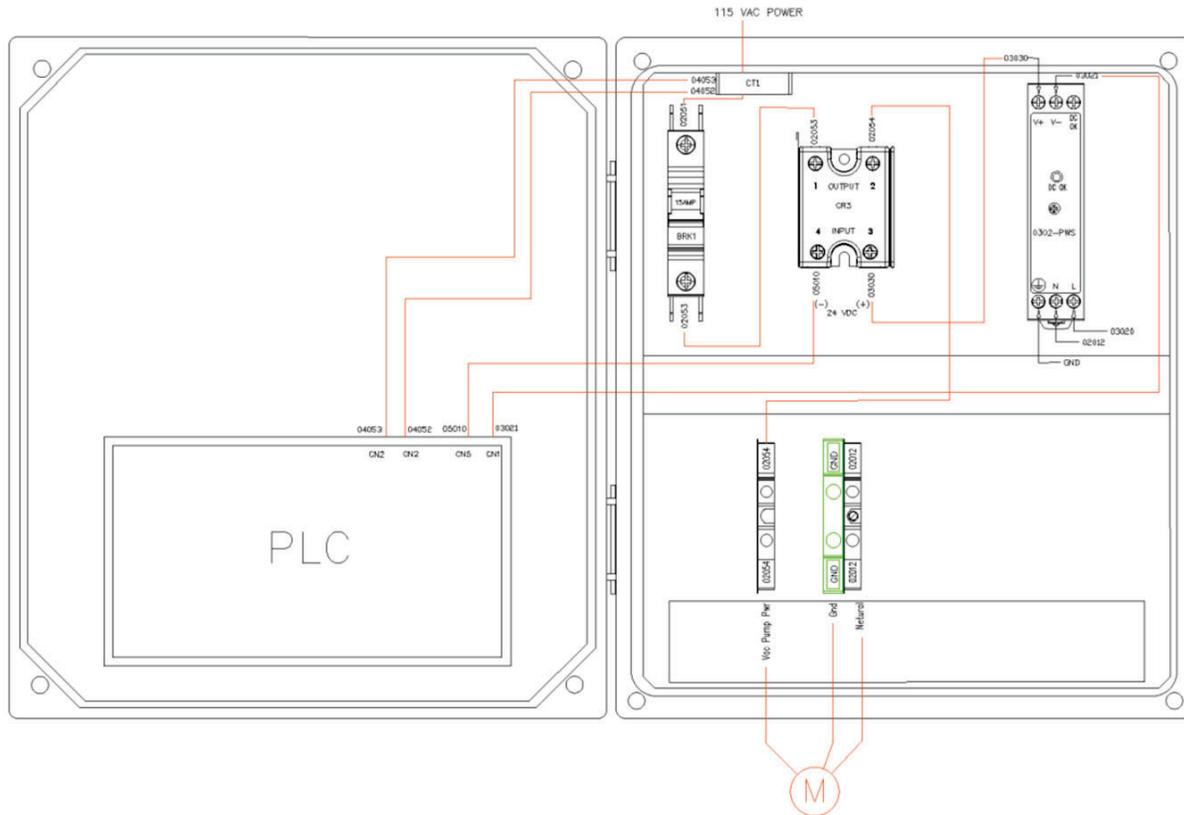
Figure 8-11: Circuito de bomba de vacío
