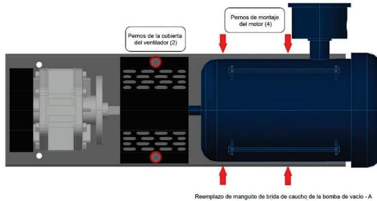
Figure 7-11: Reemplazo del buje de goma con brida de la bomba de vacío
