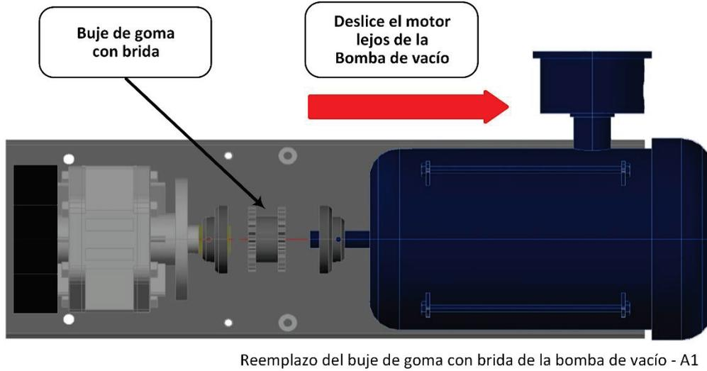
Figure 7-12: Reemplazo del buje de goma con brida
