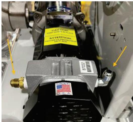
**Figure 7-8: Retire los dos tubos en la bomba.**
