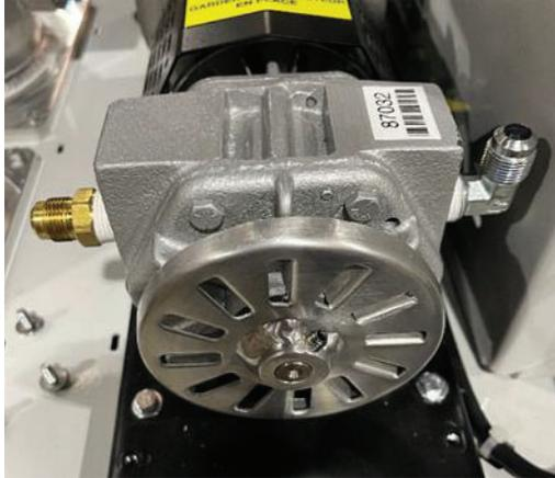
**Figure 7-9: Retire la protección del ventilador de costado.**
