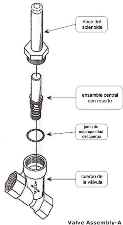
Figure 7-15: Conjunto del solenoide de la válvula
