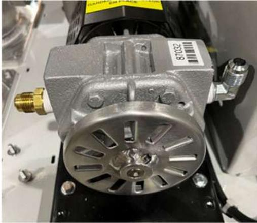
**Figure 9-8: Retire la protección del ventilador de costado**
