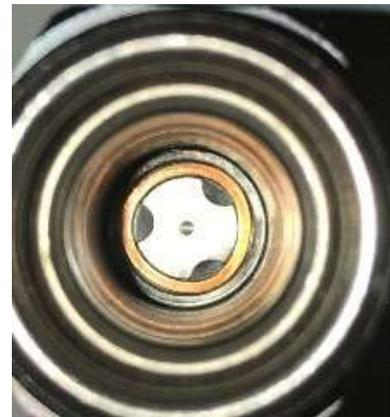
Figure 7-14: Interior de la base del solenoide
