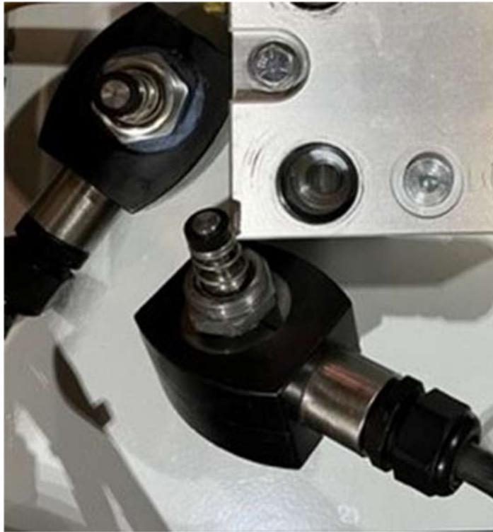
**Figure 9-24: Solenoides (con las bases para solenoides instaladas) acomodados y apartados**
