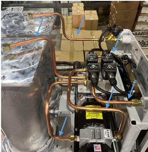
Figure 9-14: Tubería para retirar
