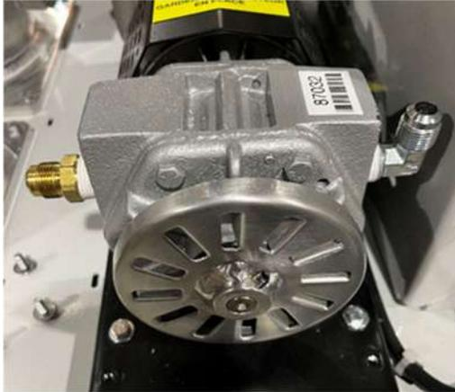
**Figure 9-18: Retire la guarda del ventilador de costado**
