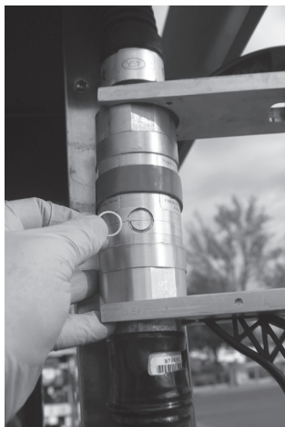
Figura 6: Agregar arandela de corte
