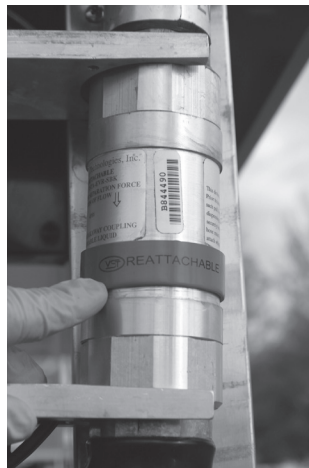
Figure 8: Vuelva a colocar el manguito de retención
