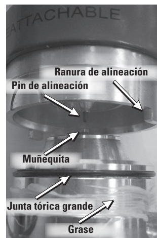
Figura 5: Alinee el pasador de resorte de la mitad superior a la inferior de la desconexión de seguridad
