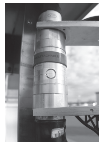
Figura 5: Alinee el pasador de resorte de la mitad superior a la inferior de la desconexión de seguridad
