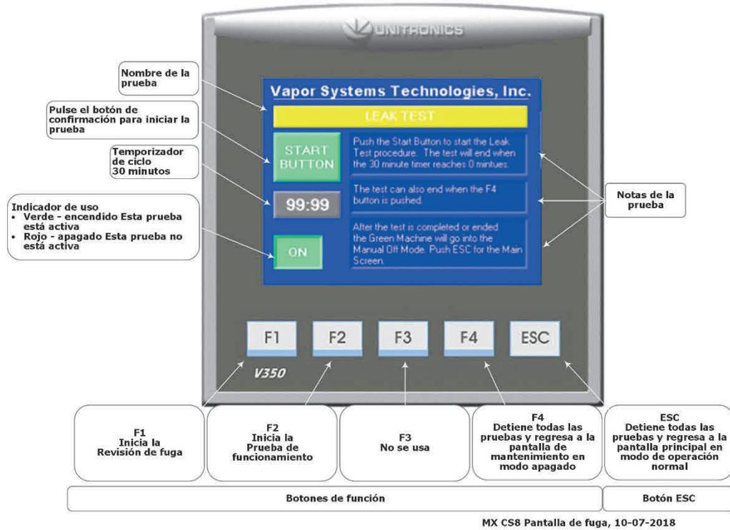
Figura: 9.38 Pantalla de la prueba de fugas
