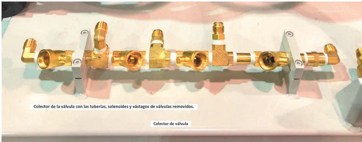
Figura: 9.32 Colector listo para su limpieza
