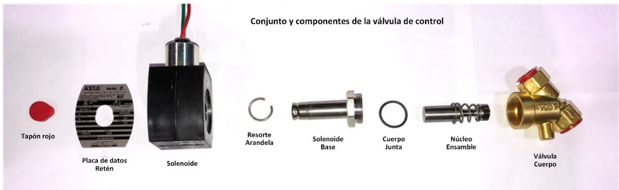
Conjunto y componentes de la válvula de control de la GM, 01-25-2019
