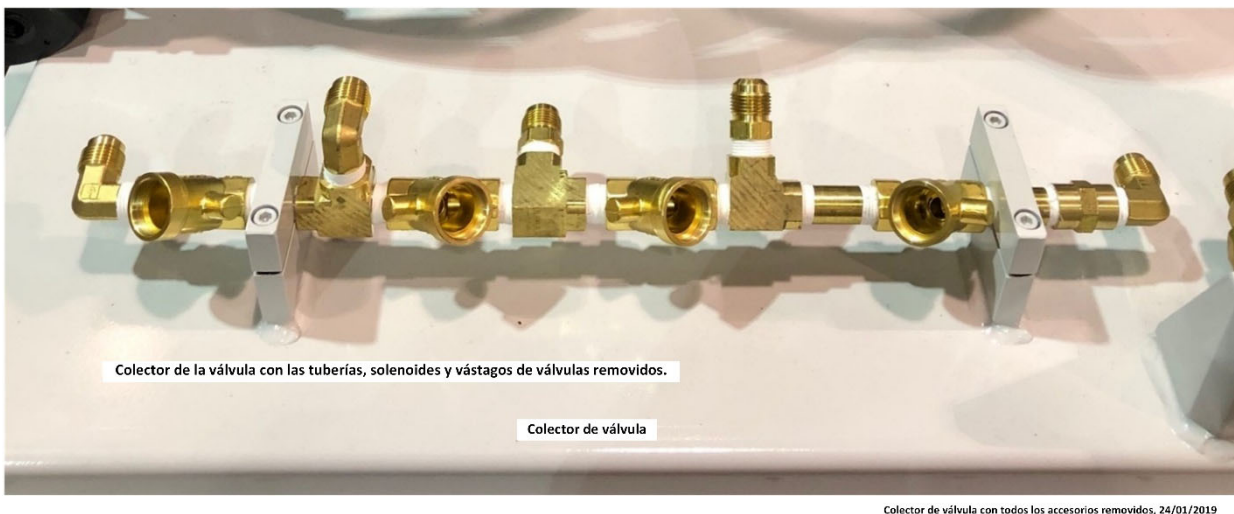
Figura: 9.28 Colector con los solenoides retirados, mostrando las bases de solenoides
