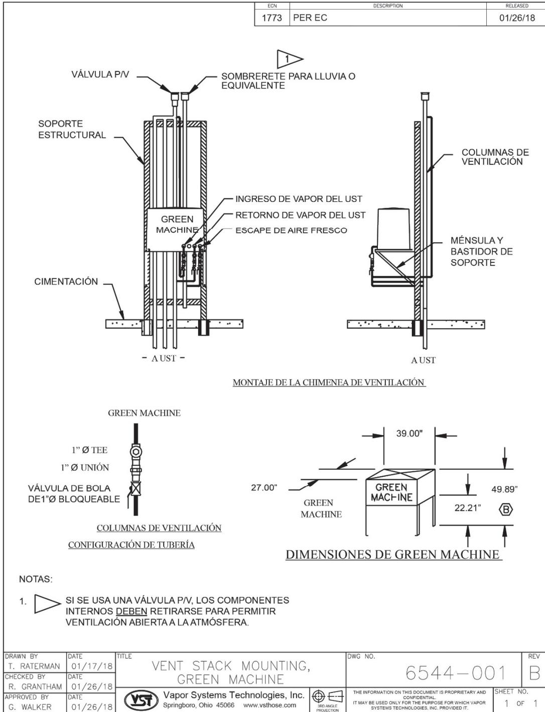
Figura: 1.4 Instalación en la chimenea de ventilación
