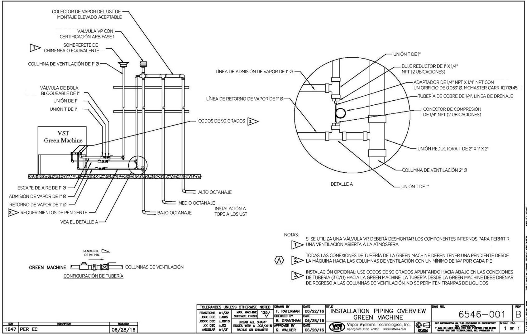
Figura 9-38: Descripción de las tuberías de vapor
