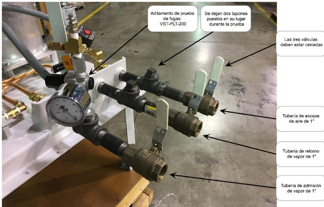
Figura 9-43: Conexiones de ingreso y retorno de vapor, y salida de aire de la GREEN MACHINE
