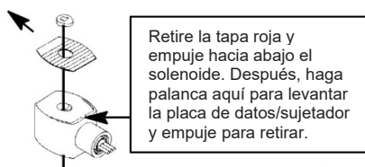
Figura 9-27: Cómo retirar el tapón rojo de la base del solenoide
