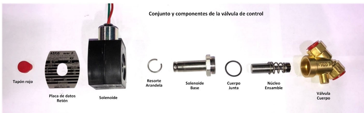
Figura 9-26: Conjunto y componentes de la válvula de control GM
